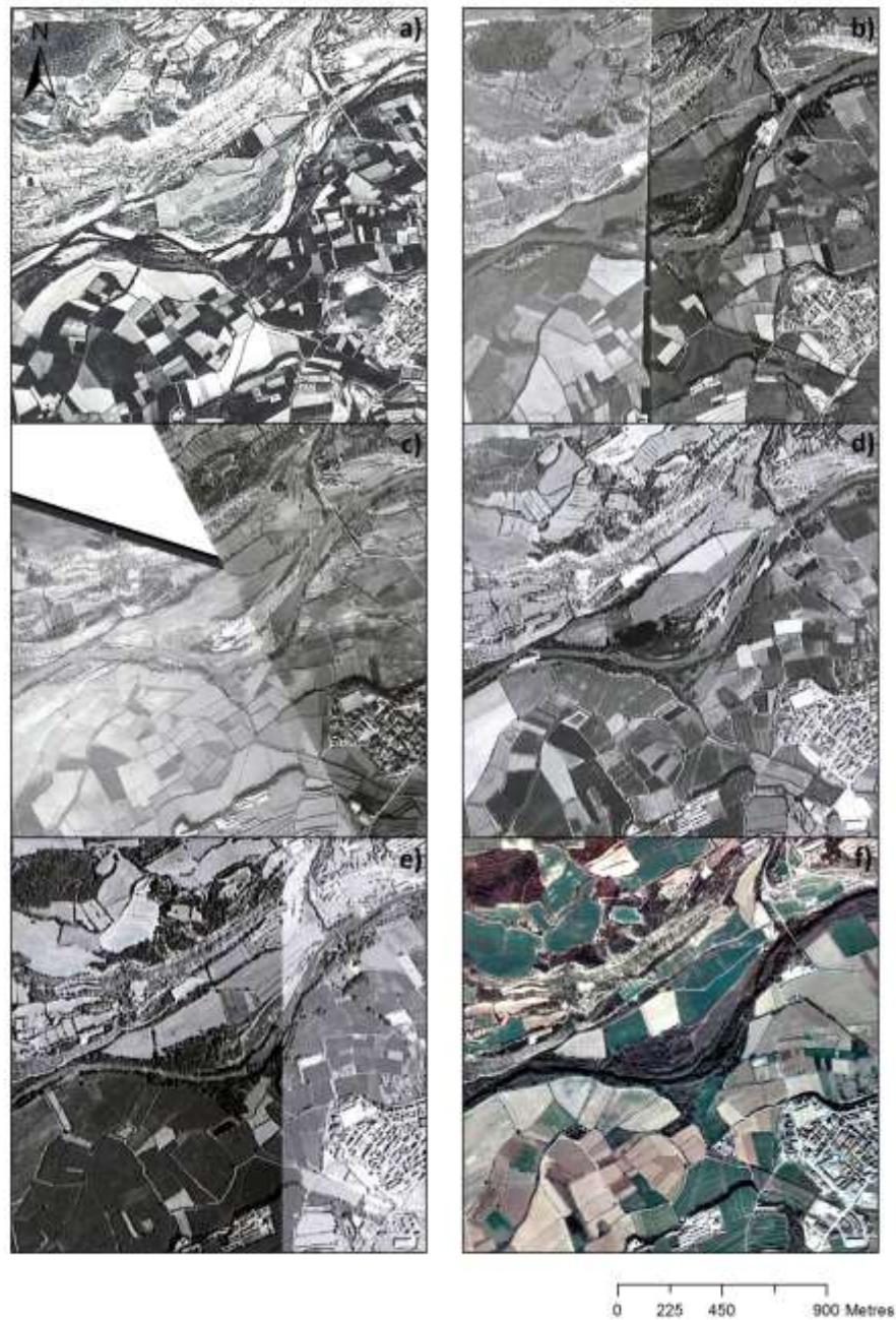
Figura D. 17 (Full 8) Fotografies aèries dels anys (a) 1956, (b) 1975, (c) 1982, (d) 1992 i del (e) 1999, i l'ortofotomapa del (f) 2008. Aquestes imatges testimonien la dinàmica morfo-sedimentària dels últims 50 anys del riu Segre entre el paratge de la Planella i el nucli urbà de Vernet (Artesa de Segre), referent a les fotografies aèries dels anys (a) 1956, (b) 1975, (c) 1982, (d) 1992 i del (e) 1999, i dels ortofotomapes del (f) 2008. Entre la imatge del (a) 1956 i del (f) 2008 s'observa una pèrdua important d'àrees sedimentàries actives (i.e. barres) i una reducció de la superfície activa de la llera a causa de la intrusió de la vegetació de ribera. La direcció del flux va d'est a oest de les imatges.
